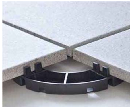
Figur 8.3 a og b: Typen til venstre er justerbar og benyttes for å korrigere fall på overflaten eller ta opp ujevnheter i underlaget de ligger på. Typen til høyre gir fast avstand til underlaget.
